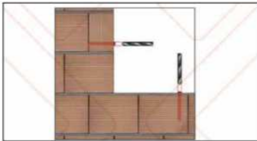
شکل ۷۶ جزئیات اجرایی آماده‌سازی اتصال در صورت اجرای بلوک‌های کناری با حفره‌های قائم
