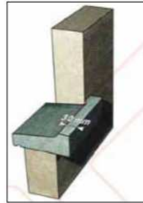
شکل ۳۴ زیر پنجره اجرا شده همزمان با سفت‌کاری دیوار
